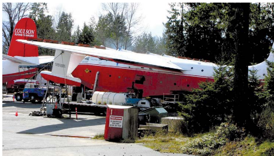
Hydroplan Mighty Mars służący do gaszenia kanadyjskich lasów. Zasysa wodę lecąc tuż nad jej lustrem, a nabiera jej aż 35 ton (polski Dromader - 2 tony). Ostatnie dwa takie egzemplarze z rocznika 1959 są wciąż czynne w służbie ratowniczej.
