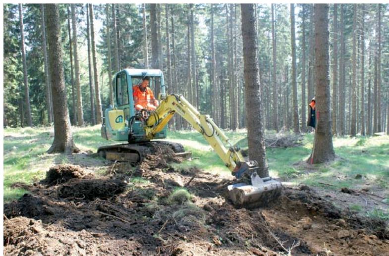
Mała koparka, zwana „kablówka” (służy głównie do kopania rowów pod kable), wyjątkowo dobrze radzi sobie w trudnym terenie (sekcja nr 1).
